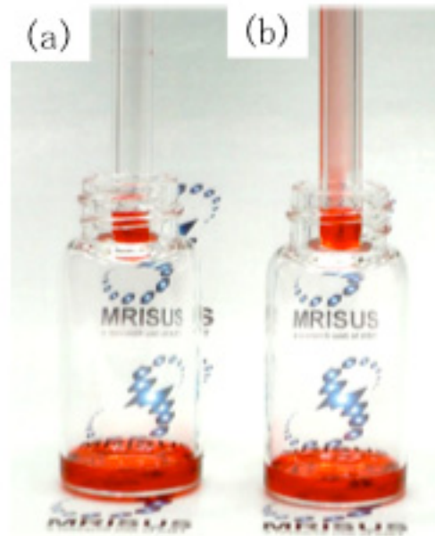
図5. 着色した n -ヘキサデカン滴下後のガラス管内壁の状態：(a) 有機-無機ハイブリッド皮膜被覆、(b) C_{10} 単分子膜被覆
